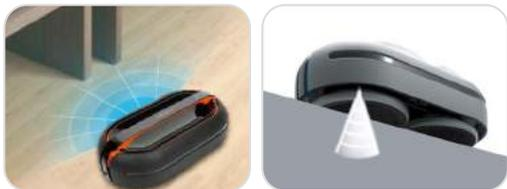
配有障碍物传感器，以最大限度地减少对家具和墙壁的碰撞，并配有跌落传感器，可以尽量避开楼梯或鞋柜等易跌落区域而进行清洁，以最大限度防止因跌落造成的产品损坏。
